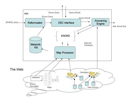
Fig. 3. Architecture of the DQS.
